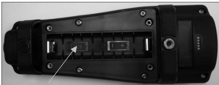
Figure 1. Pro30 avec le couvercle des piles retiré. Notez les symboles de piles indiquant les polarités.
