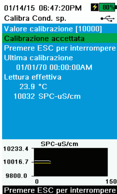
Figura 45 Calibrare la conduttanza specifica
