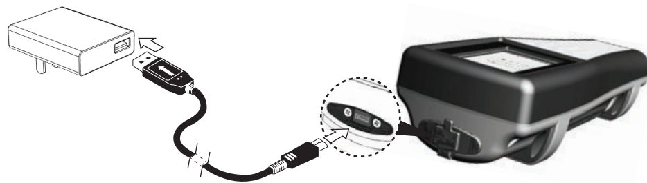
Abbildung 1 ProDSS mit der Stromversorgung verbinden
