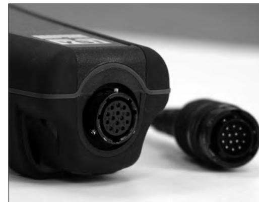
Figure 5. Notez le connecteur à clé. Les connecteurs du câble et de l'appareil peuvent être accouplés uniquement lorsque les sections à clé sont alignées de manière appropriée.
